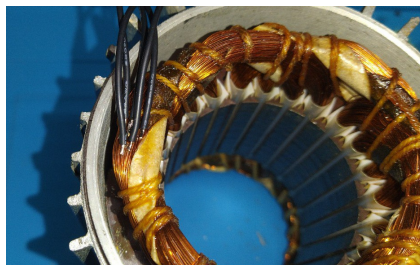
Рис. 2. Искусственное повреждение обмотки статора с выводами для управления режимом межвиткового замыкания
